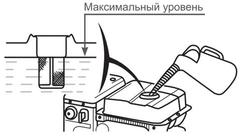
Рис. 11 Максимальный уровень топлива в топливном баке
