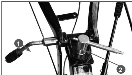
**Рис. 5 Установка рабочих рукояток**
