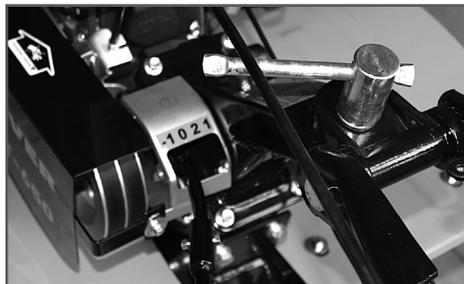
Рис. 16 Коробка передач мотоблока
